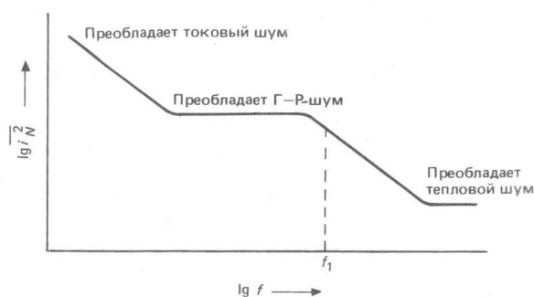
Рис. 3.7. Частотный спектр шумового тока в полупроводниках.
