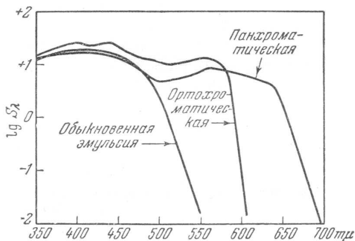
Рис 3.3. Кривые спектральной чувствительности некоторых типов эмульсий.
